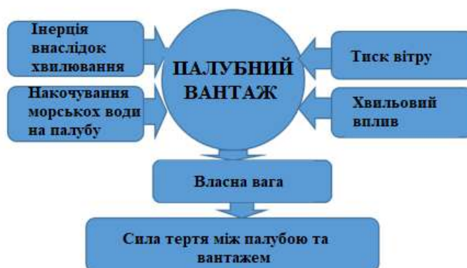
Рисунок 6.3 - Сили, що діють на палубний вантаж під час транспортування.
