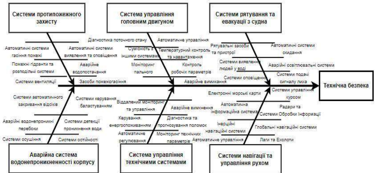
Рисунок 3.1 – Елементи системи технічної безпеки судна
