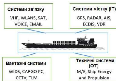
Рисунок 12 - Ключові системи судна, вразливі для кібератак
